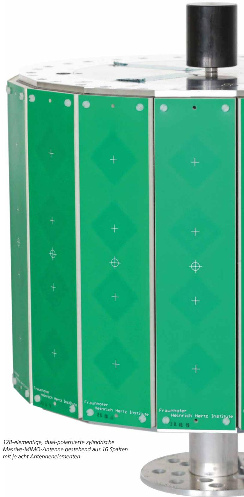
128-elementige, dual-polarisierte zylindrische Massive-MIMO-Antenne bestehend aus 16 Spalten mit je acht Antennenelementen.
