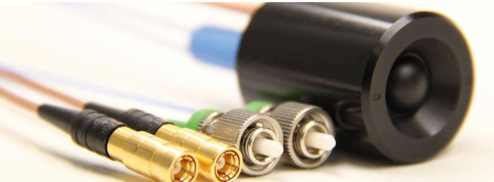
Der vom Fraunhofer HHI entwickelte Terahertz-Sensorkopf ist so groß wie eine 1-Euro-Münze.
